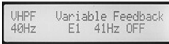
Il VHPF è un filtro che consente alle frequenze sopra una determinata soglia (modificabile tramite il controllo Filter) di essere riprodotte, tagliando nel frattempo quelle inferiori.
