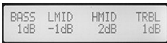
Tenendo premuto il potenziometro Filter/BASS per 2 secondi, potrete regolare le frequenze di intervento delle 4 bande di equalizzazione. L'intervallo di frequenze del controllo dei bassi è da 40Hz a 120Hz a passi di 5Hz. Potrete tornare alla schermata Home premendo uno qualsiasi dei controlli di tono, oppure aspettando 5 secondi.
