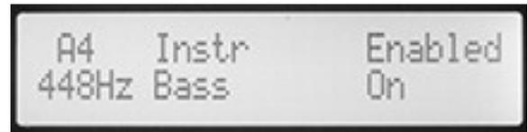
Inoltre permette di ottimizzare velocità e accuratezza dell'accordatore per basso o chitarra ruotando il controllo Lmid/Mem1 fino a selezionare lo strumento desiderato.
